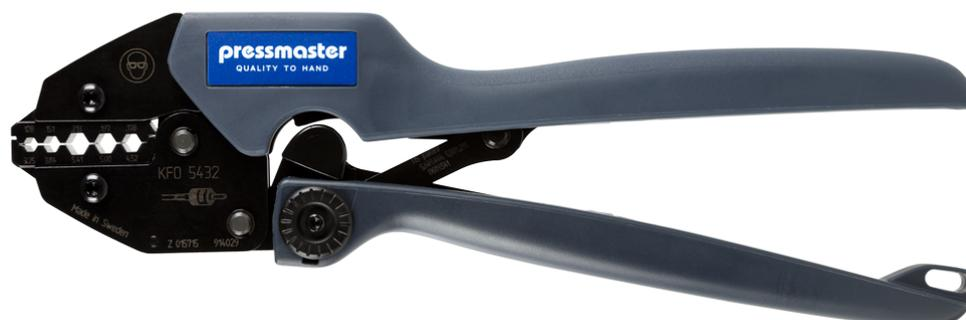
KFO-5432 est un outil de sertissage pour Connecteurs Fibre optique; 3,25 mm; 3,84 mm; 5,41 mm; 5,00 mm; 4,52 mm/0,128"; 0,151"; 0,213"; 0,197"; 0,178", sertissage hexagonal, ST, SC, SMA, SMB, SFR.
