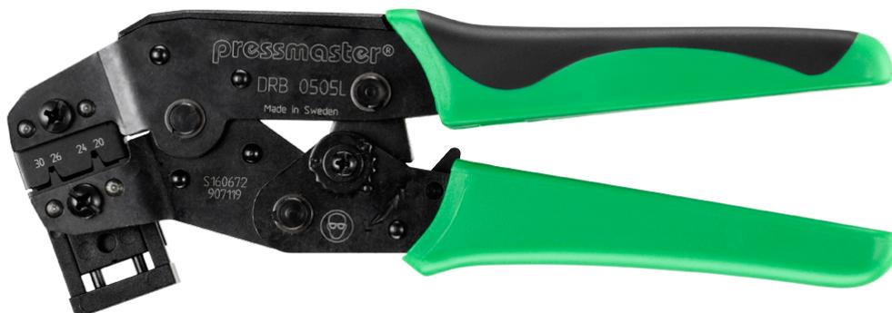
DRB-0505 L è adatto per la crimpatura di contatti Sub-D 0,05-0,50 mm<sup>2</sup> / AWG 30-20, forma "B", con posizionatore.
